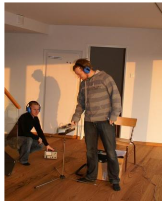
Figur D.3. Måling af efterklangstid i Komforthusene.
