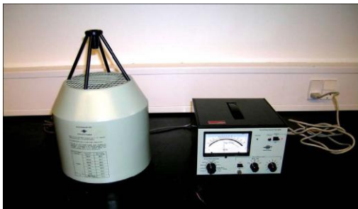
Figur D.1. Udstyr til måling af efterklangstid. Fra venstre lydkilde, lydgenerator, skriver og lydtrykmåler. [Hyldgård]
