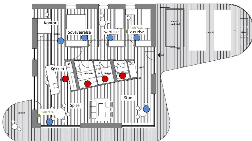
Figur 3.20. Placering af temperaturmålingerne i stue og værelse (markeret med grønt) samt indblæsning (blå cirkler) og udsugning (røde cirkler) af ventilationsluft.
